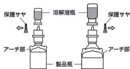
6. 溶解液注入針を溶解液瓶（空瓶）と共に抜去し、製品瓶をなるべく泡立てないようゆるやかに揺り動かして溶解する。
